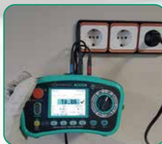
壁式插座的回路试验
