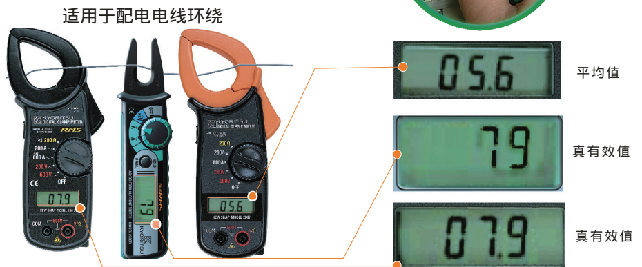
图例：晶闸管控制发动机负荷测试,真有效值测试仪显示7.9A,平均值测试仪显示6.5A。
